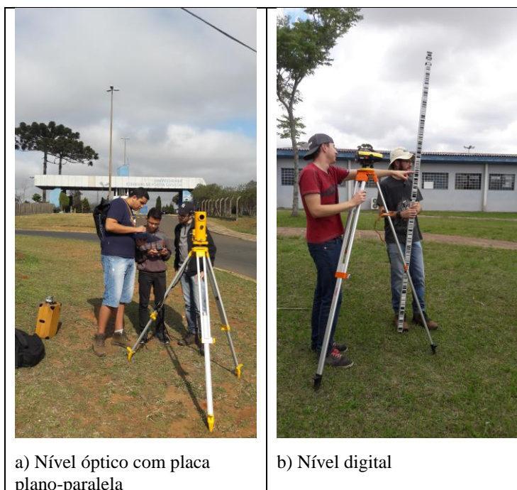
FIGURA 2 – REALIZAÇÃO DOS LEVANTAMENTOS TOPOGRÁFICOS
