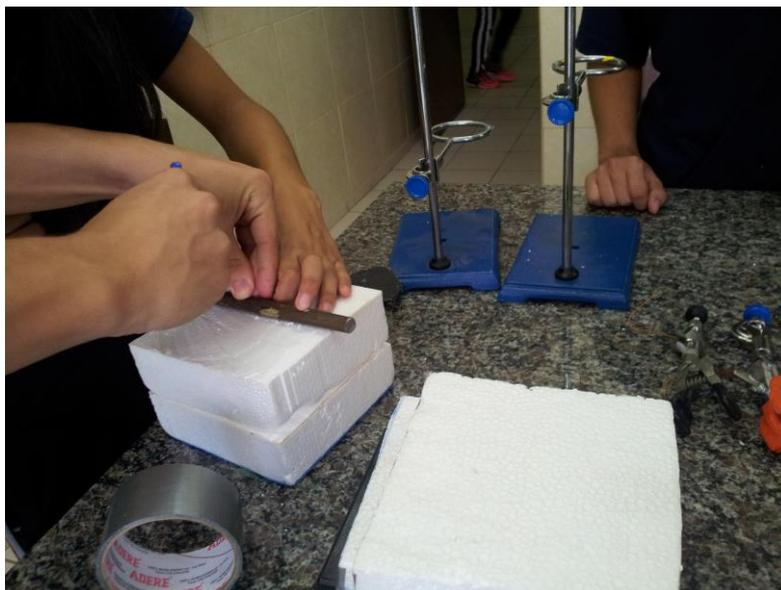
Montagem inicial do material didático. Corte do material utilizado como isolante térmico (isopor) e preparação da cavidade onde o metal será inserido.
