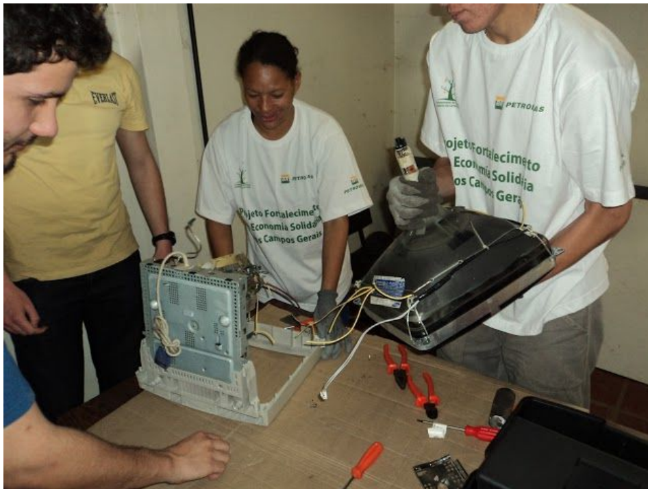
Imagem 1 - Catadores desmontando um monitor CRT
