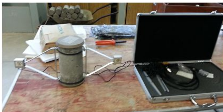
Figura 3 – Exemplificação do ensaio de determinação do módulo de elasticidade do concreto
